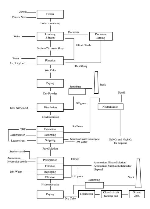
FIG 5 : PROCESS FLOW SHEET FOR PRODUCTION OF  $$\rm ZrO_2$  POWER
